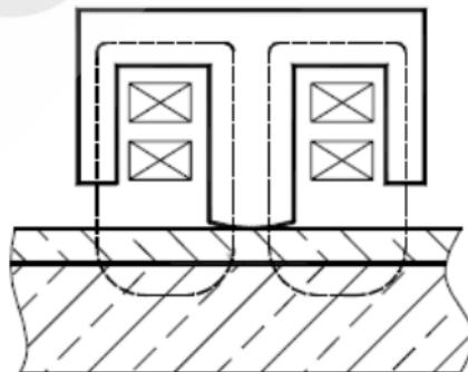
图 1 磁性法基本工作原理
