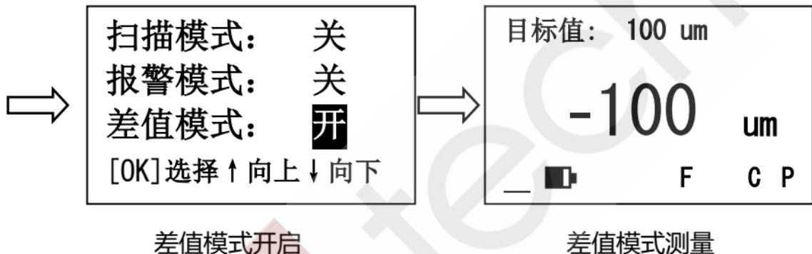
开启差值模式后，测量界面下，屏幕顶部会显示当前设置的目标值，屏幕中间显示的读数则是实际测量值与目标值的差值。
