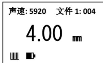
4、短按声速键 **VEL** 切换到声速显示界面，检查**声速设置**是否正确（详见第31页，第4.2节），如果不知道被测工件的准确声速值，请使用**反测声速**功能（详见第38页，第4.5节）。
