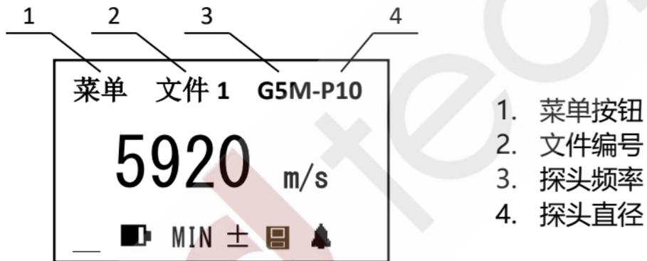
图 5 液晶显示示意图 - 菜单栏显示界面
