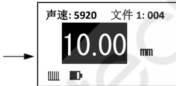
b. 按 VEL 键显示出被测声速,显示如下图所示:
