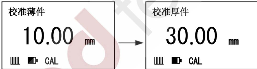
**注：仅当实际测量的试件厚度在两个校准试件厚度之间时才能有效地提高测量精度。**
