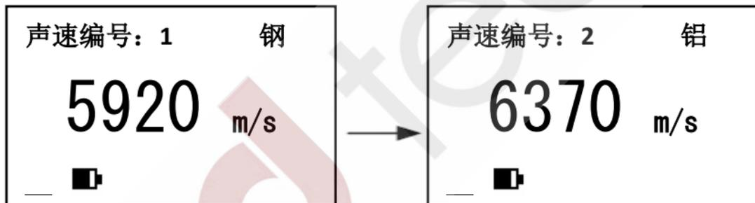
每组声速都可以单独设置，按 **SCAN** 键或 **ALARM** 键将声速调整到期望值即可，如下图所示：
