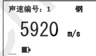
5、在清洁干净的工件表面涂抹**耦合剂**，使用探头对涂抹耦合剂的地方进行**测量**（详见第36页，第4.4节）。如果被测工件是弧面，请参考《3.3测量圆柱型表面》。
