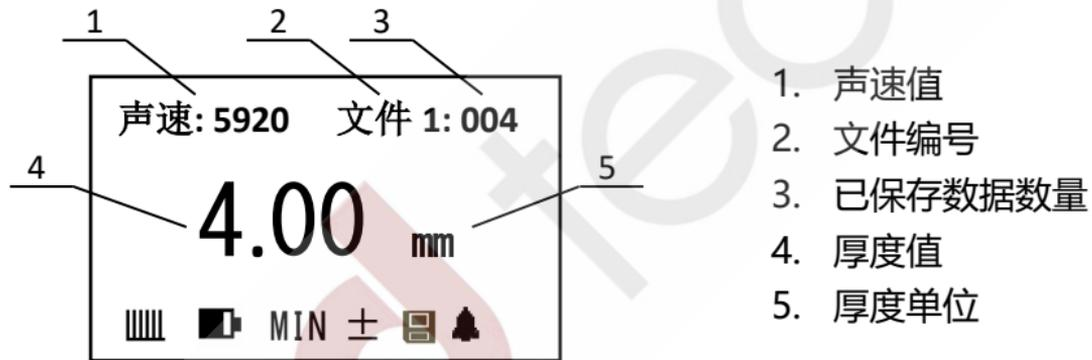
图 4 液晶显示示意图 - 厚度显示界面
