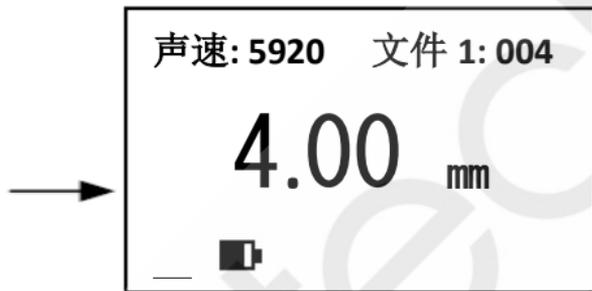
当探头与被测材料耦合时，显示耦合标志。如果耦合状态指示条少于5个说明耦合不好。
