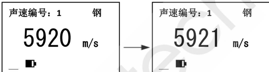
由于测量精度较高，声速的微小变动直接影响测量结果，特别是对于较厚被测物，所以精确测量要求输入精确的声速值。如果对被测物声速不确定，也可以采用“反测声速”章节中的方法取一个相同材质的已知厚度试块来测量声速。另外声速会随温度变化而变化，测量中应注意随温度变化更新声速值。
